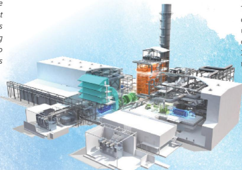
新複式循環燃氣渦輪發電機組概念圖
